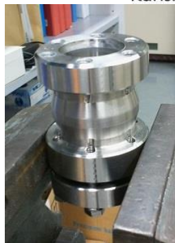
Pompa a membrana per l'alimentazione del reattore ad alta pressione
