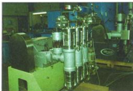
Pompa a membrana per l'alimentazione del reattore ad alta pressione
